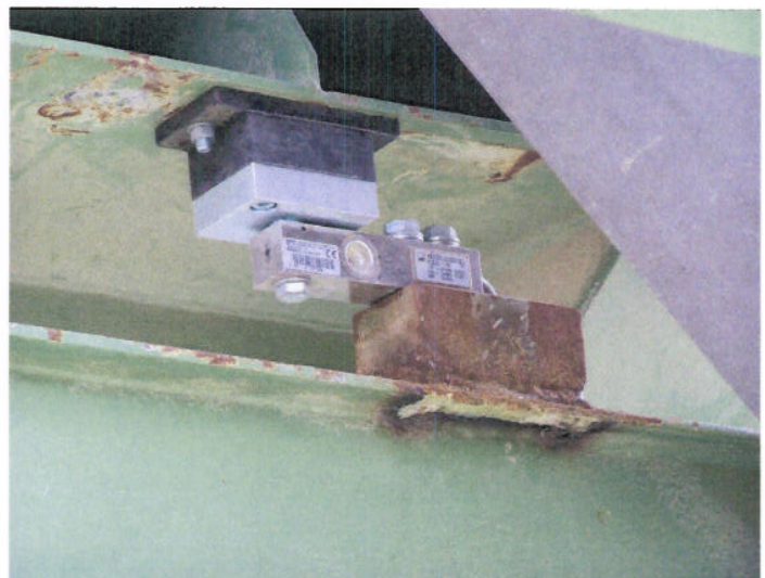
Izgled vage za agregat i način oslanjanja na MPS u slučaju bez polužnog sistema
